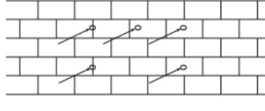
Stecken Sie die Dehnungsröhre in die Löcher und ziehen Sie sie fest. Montieren Sie die Halterung mit den Dehnschrauben.
