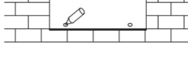
Bohren Sie die Löcher mit einer elektrischen Bohrmaschine, stellen Sie sicher, dass die Löcher mindestens 50 mm tief sind, und ziehen Sie dann die Dehnungsröhre fest.
