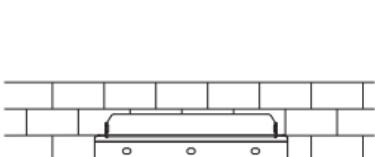
Schritt 2: Anpassen des Wechselrichters an die Wandhalterung
