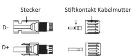
Führen Sie das abisolierte Kabel in den Stiftkontakt ein und achten Sie darauf, dass alle Leiterlitzen im Stiftkontakt erfasst werden.
